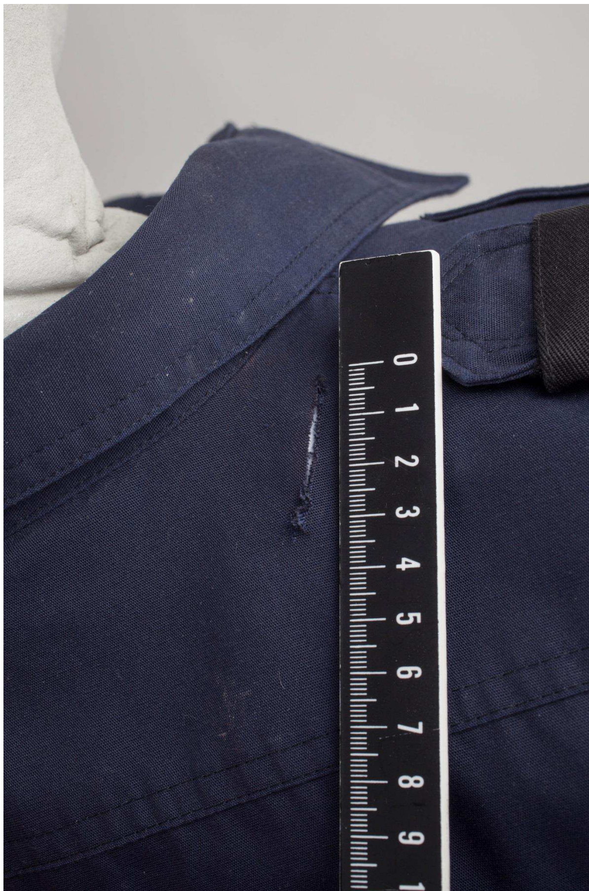
Figur 7. Närbild på den skarpkantade skadan.
